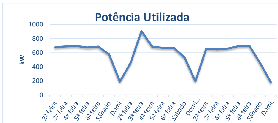
Figura 28 - Potência Utilizada pela Central de Ar Comprimido
